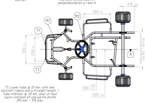
T2: Upper tube ∅ 16 min. with one constant radius and a straight length: / Tube supérieur \( \phi \) 16 min. avec un seul rayon constant et une partie droite: 375 min. - 395 max.
