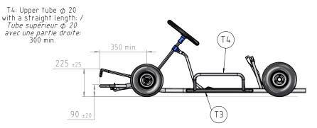
T3: Lower tube Ø 20 with a straight length: / Tube inférieur \$\phi\$ 20 avec une partie droite: 400 min.
