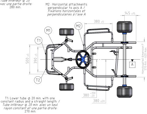
T2: Upper tube Ø 16 min. with one constant radius and a straight length: / Tube supérieur Ø 16 min. avec un seul rayon constant et une partie droite: 300 min.
